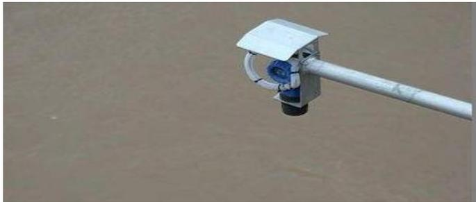
SNC-100 系列超声波水位计的工作原理是由换能器（探头）发出高频超声波脉冲遇到被测介质表面被反射回来，部分反射回波被同一换能器接收，转换成电信号。超声波脉冲以声波速度传播，从发射到接收到超声波脉冲所需时间间隔与换能器到被测介质表面的距离成正比。此距离值  $S$  与声速  $C$  和传输时间  $T$  之间的关系可以用公式表示： $S=C \times T/2$ 。由于发射的超声波脉冲有一定的宽度，使得距离换能器较近的小段区域内的反射波与发射波重叠，无法识别，不能测量其距离值。这个区域称为测量盲区。盲区的大小与超声波物位计的型号有关。
