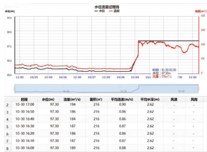
明渠雷达流量计计算当前流量Q的方法基于连续性方程 ( $Q=V \times A$ )，Q=流量；V=平均流速，A = 过水断面面积，其中断面平均流速由表面流速 $V_{surf} \times$ 转换系数获得。
