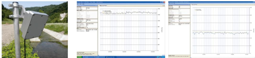
RVS-1 雷达流速仪采用了 DSP技术和先进的phyTrack速度检测与跟踪算法，是一款专门针对水体表面流速特征而开发的雷达波流速仪
